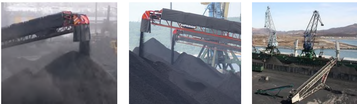
Рисунок 70 –Источники пыления в конвейерных транспортных системах
