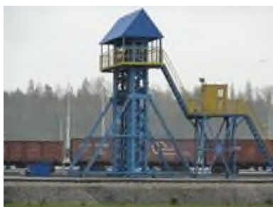
Бурильная установка для рыхления угля в вагоне
