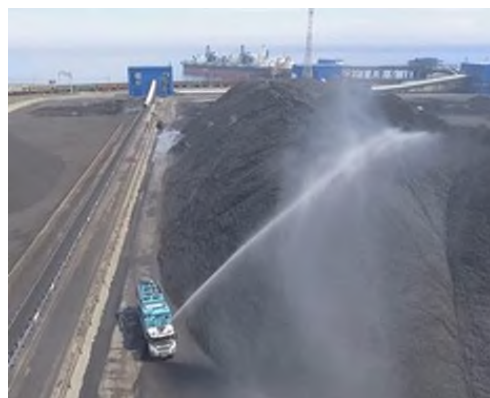
Рисунок 74 – Распыление воды стационарными и мобильными дождевальными (поливальными) установками и гидромониторами
