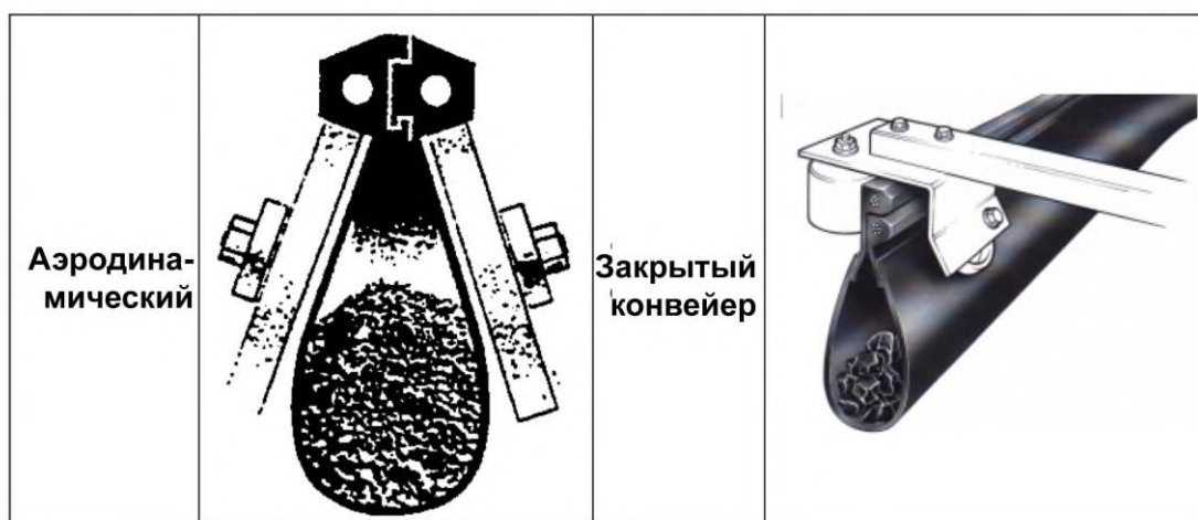
Рисунок 31 – Примеры подвесных ленточных конвейеров
