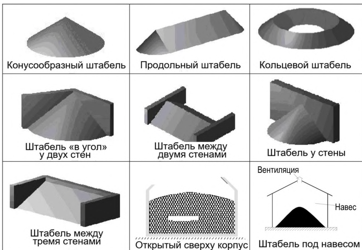
Рисунок 19 – Типы штабелей навалочного груза
