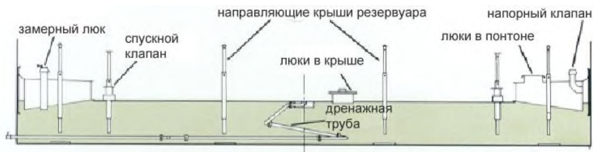
Рисунок 2 – Пример типичной плавающей понтонной крыши
