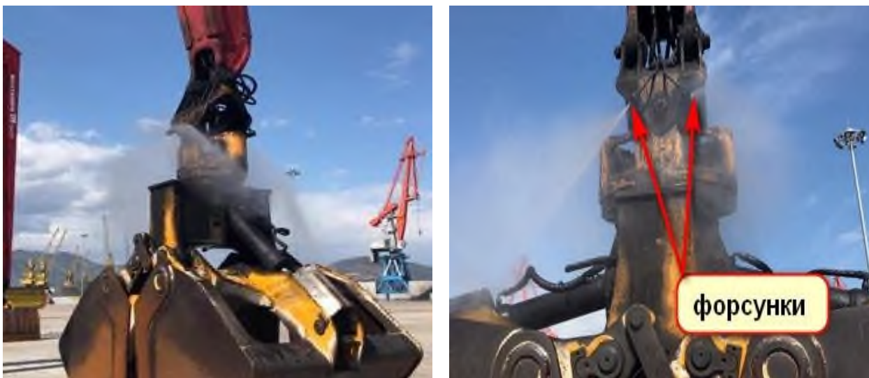
Рисунок 111 – Система пылеподавления на грейфере перегружателя
