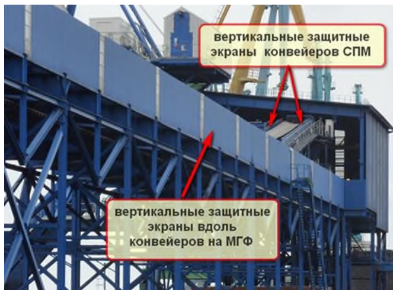
Рисунок 56 – ТКС с боковой ветропылезащитой
