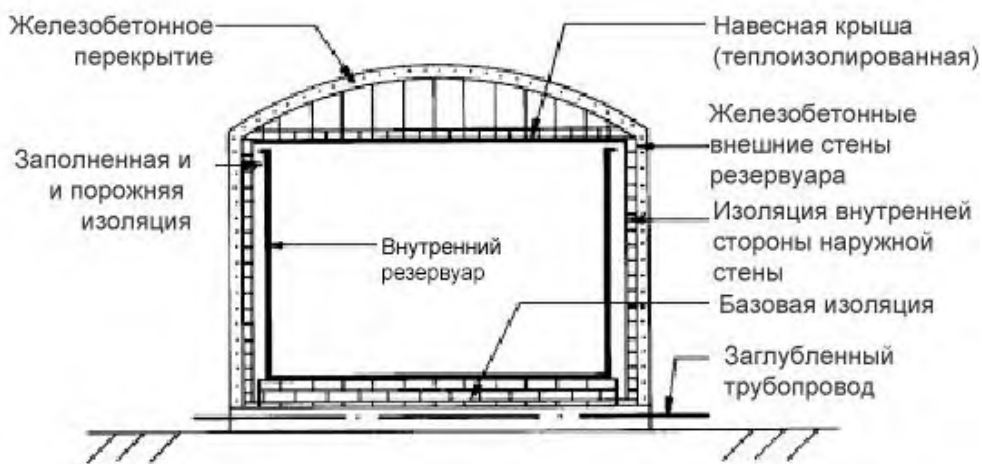
Рисунок 11 – Резервуар с полной защитной оболочкой
