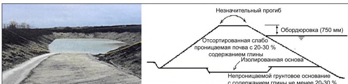
Рисунок 14 – Пример организации пруда-отстойника
