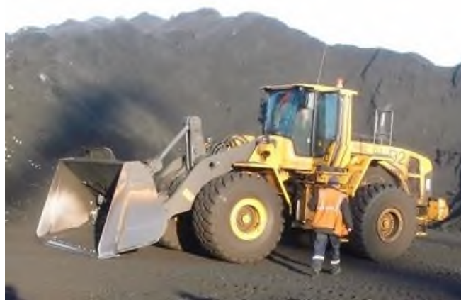
Рисунок 63 – Ковшевой автопогрузчик для штивки угля
