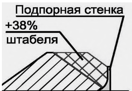
Рисунок 90 – Подпорные стенки для штабелей угля на складе
